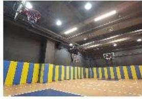
2、在场地周围的墙面2m高处设立防撞护墙，采用专业防撞护墙板。
